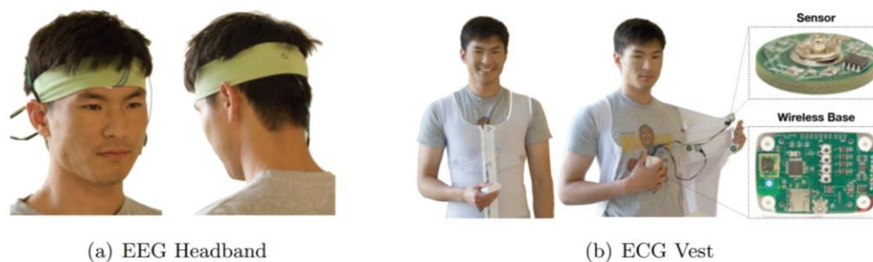
1.5 сурет - Жанаспайтын электродтарды қолданатын киілетін құрылғылар
